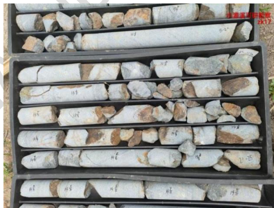
图3.3-2 右岸坝肩钻孔岩芯卸荷带现状
